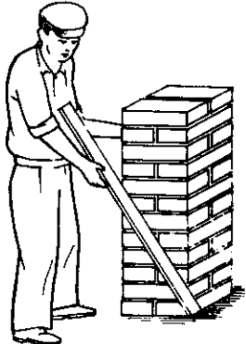
Hình3-8: Kiểm tra mặt phẳng trụ
