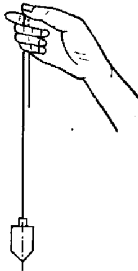
Hình 1-8: Cách cầm dây dọi
